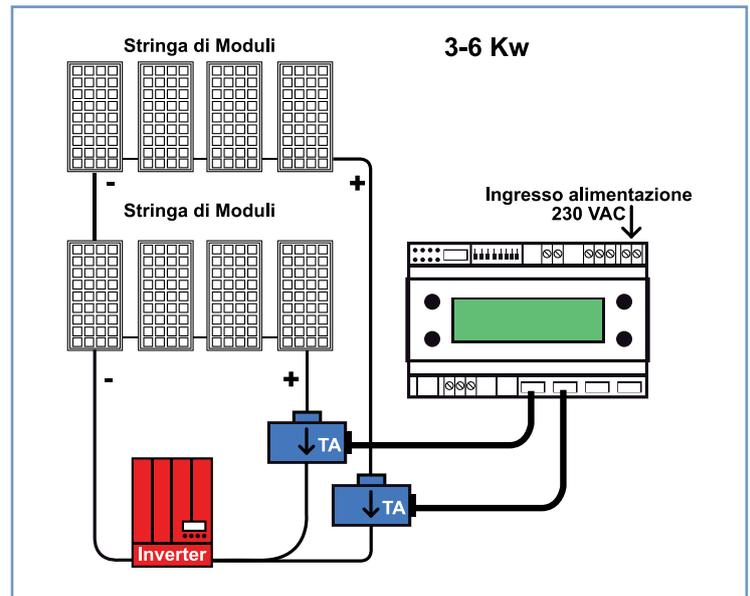
Al MFV08B-LCD possono essere collegate fino ad un massimo di 4 sonde di corrente esterne da 25A ( TA ad effetto Hall ) per la verifica di più stringhe, se l'impianto è realizzato con più stringhe o più inverter.
