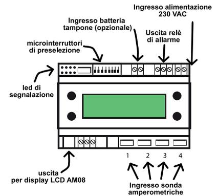
MFV08B-LCD è alimentato dalla linea 230Vac ( con l'opzione di una batteria tampone).
